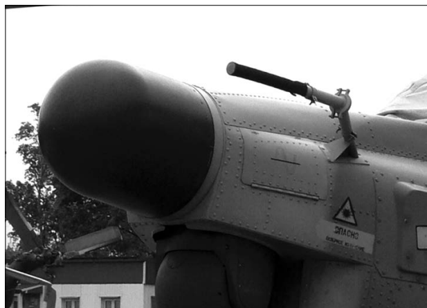
Антенна радиоканала наведения ПТУР «Штурм» и «Атака»
