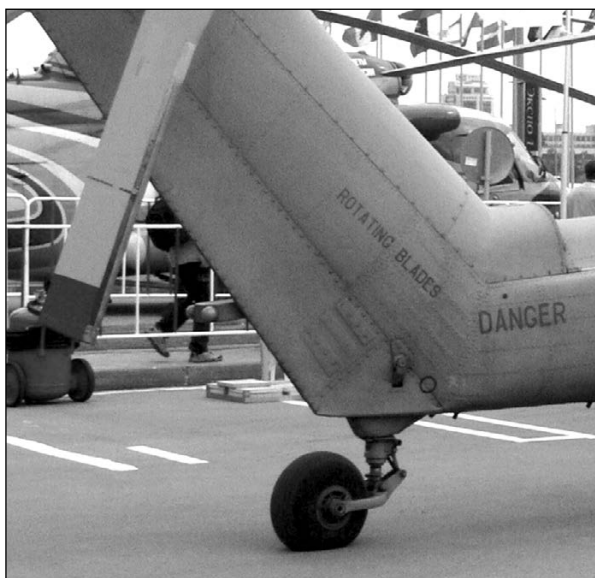
Хвостовая опора шасси
