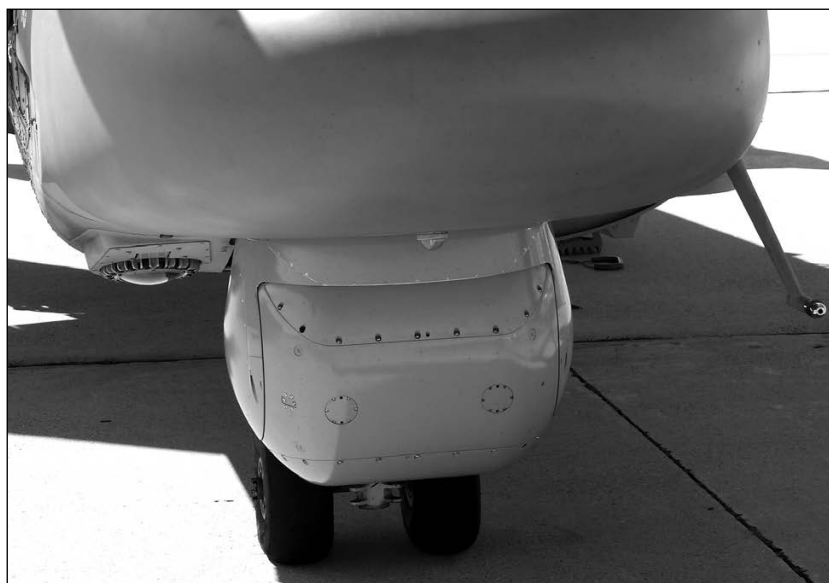
Обзорно-прицельная система в походном положении
