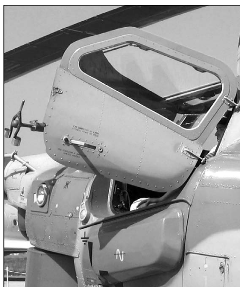
Дверь кабины штурмана и обтекатель уложенный под него надувного аварийного трапа
