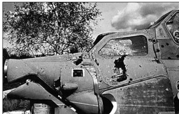
Кабина штурмана вертолета «Ми-28» после отстрела из зенитной самоходной установки ЗСУ-23-4 «Шилка»
