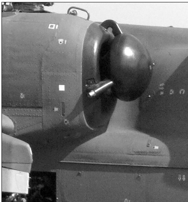
Воздухозаборник с пылезащитным устройством двигателя «Ка-52»
