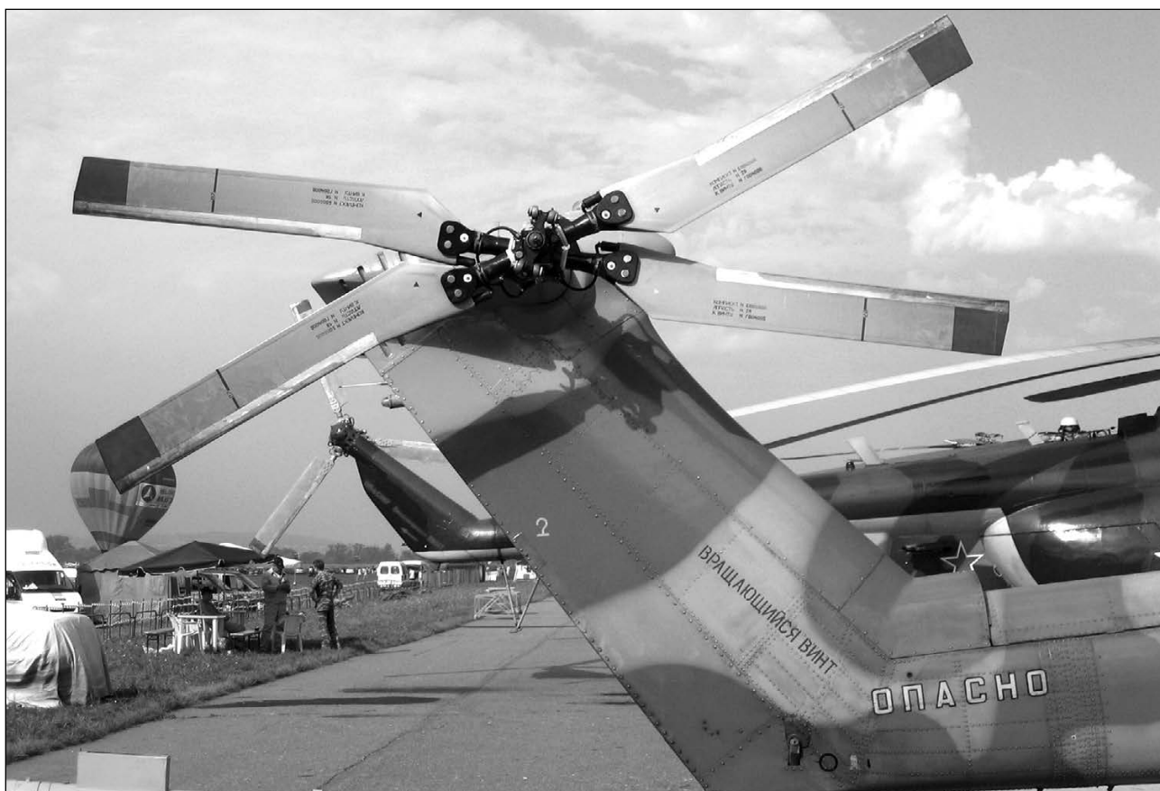
Х-образный хвостовой винт
