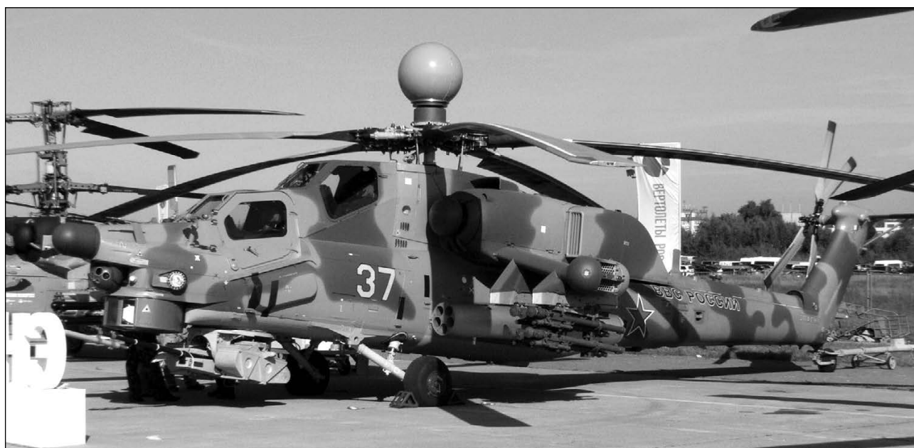
Шестой экземпляр «Ми-28Н» установочной серии с ракетами «9М39-2» класса «воздух-воздух» комплекса «Игла-В»
