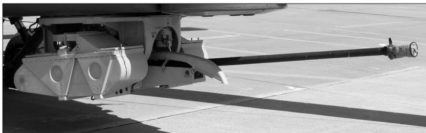
Артиллерийская установка вертолета «Ми-28Н»
