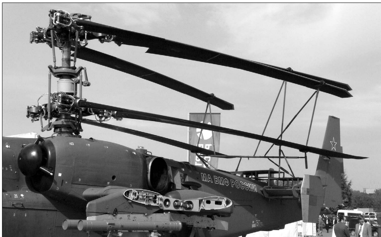
Для хранения «Ка-52К» в ангаре вертолетоносца лопасти несущих винтов складываются
