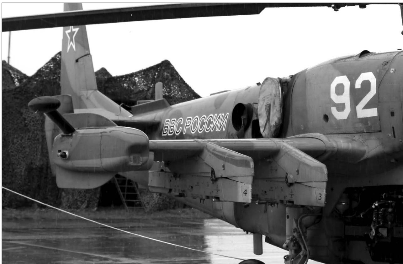
Крыльевые устройства подвески внешних грузов
