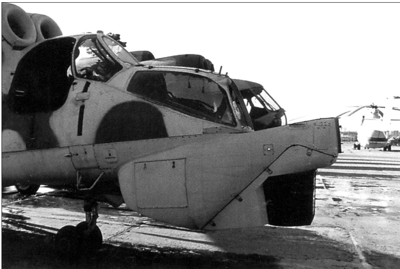
Летающая лаборатория «Ми-24» для доводки и испытаний прицельно-пилотажно-навигационного комплекса «Ми-28»
