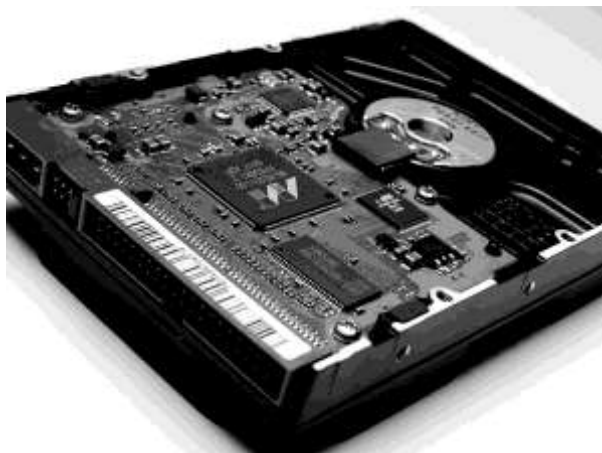
Рис. 3.7. Интерфейсы жесткого диска. Перемычки должны устанавливаться на штекерные разъемы, расположенные между интерфейсом для подвода электропитания и интерфейсом для подключения шлейфа данных
