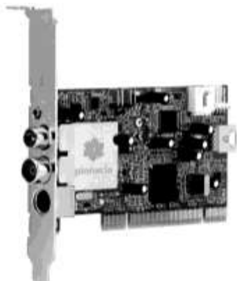
Рис. 2.9. Современные TV-карты чаще всего имеют вход S-Video
