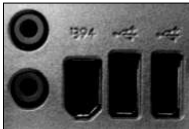
Рис. 2.19. На многих компьютерах интерфейс FireWire обозначался просто цифровой последовательностью 1394 (в данном случае — большой 6-контактный разъем)
