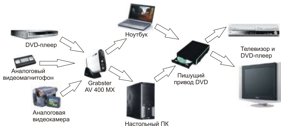
Рис. 2.11. Варианты подключения видеограббера Grabster AV 400 MX
