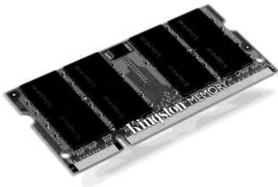
Рис. 3.2. Модуль DDR2 SO DIMM — вид памяти, применяющийся в ноутбуках
