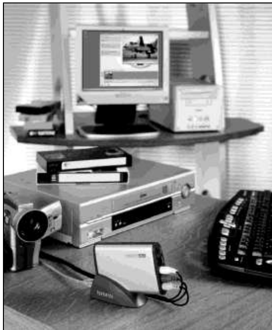
Рис. 5.1. Видеорекордер или видеокамера подключены композитным кабелем к видеограбберу
