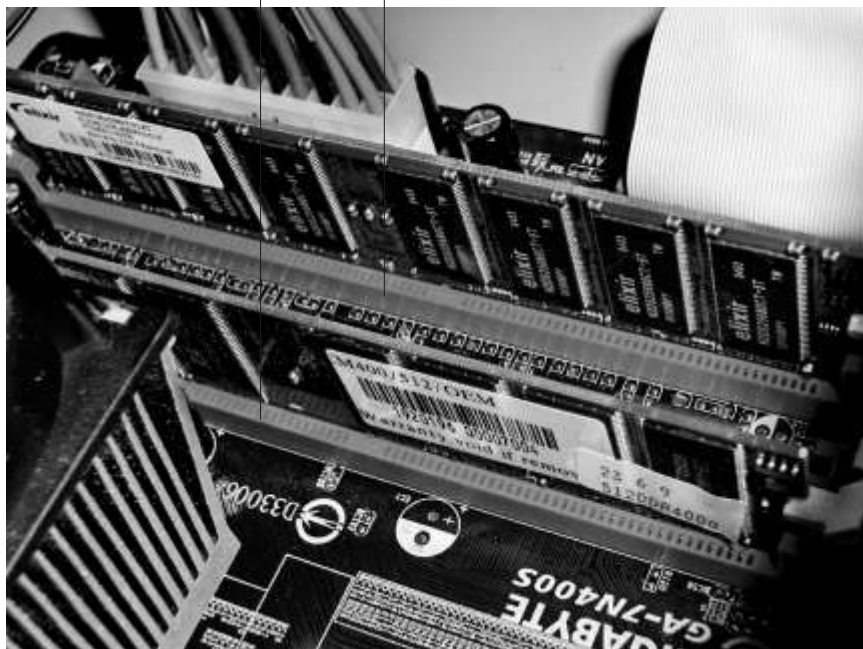
Рис. 3.3. На многих материнских платах банки памяти выделены цветовой маркировкой
