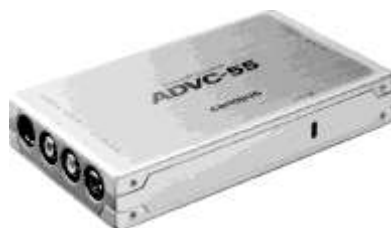
Рис. 2.12. Аналого-цифровой преобразователь от Sanopus преобразует аналоговые видеоданные в поток данных формата DV, который он передает через соединение FireWire на компьютер для дальнейшей обработки
