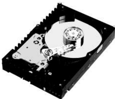
Рис. 3.6. Внутреннее устройство жесткого диска WD Raptor
