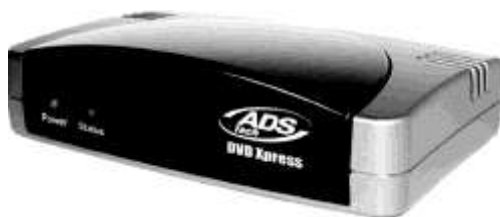
Рис. 2.13. Более дешевые преобразователи, подключаемые через USB, например, DVD Express от ADS Tech, предоставляют компьютеру осуществление ресурсоемкого преобразования в формат MPEG
