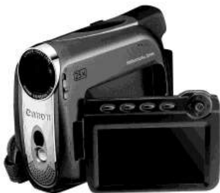
Рис. 2.4. Среди видеокамер MiniDV можно найти дорогие модели с видеовходом S-Video и встроенным аналого-цифровым преобразователем — такие, как эта модель Canon MV960
