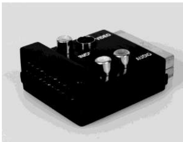
Рис. 2.17. Если ваш видеомagniтофон VHS оборудован только разъемом SCART, проблему с подключением можно решить при помощи такого адаптера
